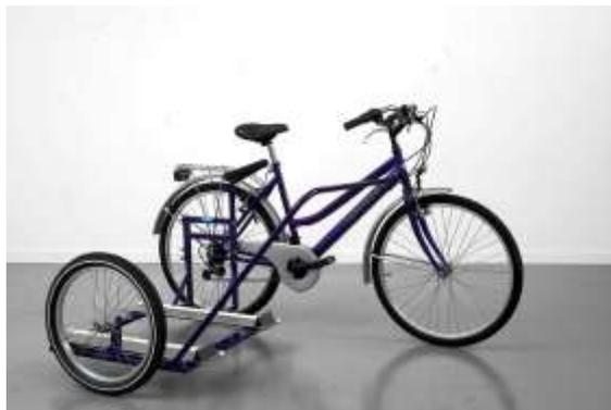
Bicicletta concepita per il trasporto di una persona diversamente abile sulla carrozzina. La pedana è provvista di due binari di distanza regolabile e due ganci per l'ancoraggio della carrozzina. Side car laterale estraibile per facilitarne il trasporto.
